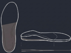
Abb. 1: Fersenerhöhung bis 5 mm
